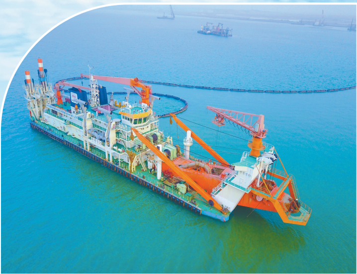
“铁建绞01”是国内自主设计建造的大型非自航绞吸式挖泥船,设计生产能力每小时5000立方米,中国铁建港航局依托该船进行的《海上大型绞吸疏浚装备的自主研发与产业化》科研课题荣获国家科技进步奖特等奖。 陈超 摄
