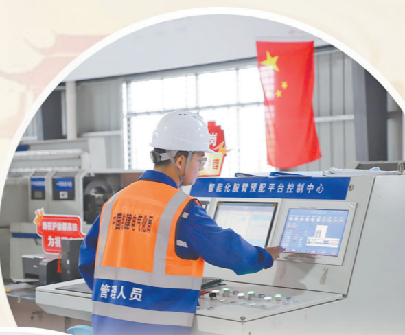
▲10月1日,沪渝蓉高铁武宜段接触网预配车间,中铁建电气化局员工正在操作台设置腕臂参数。陈思 摄
