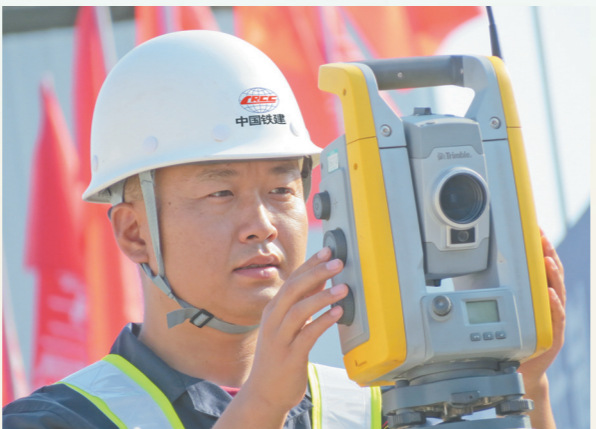
田国锐在施工现场开展导线控制测量工作。 李李佳 摄
