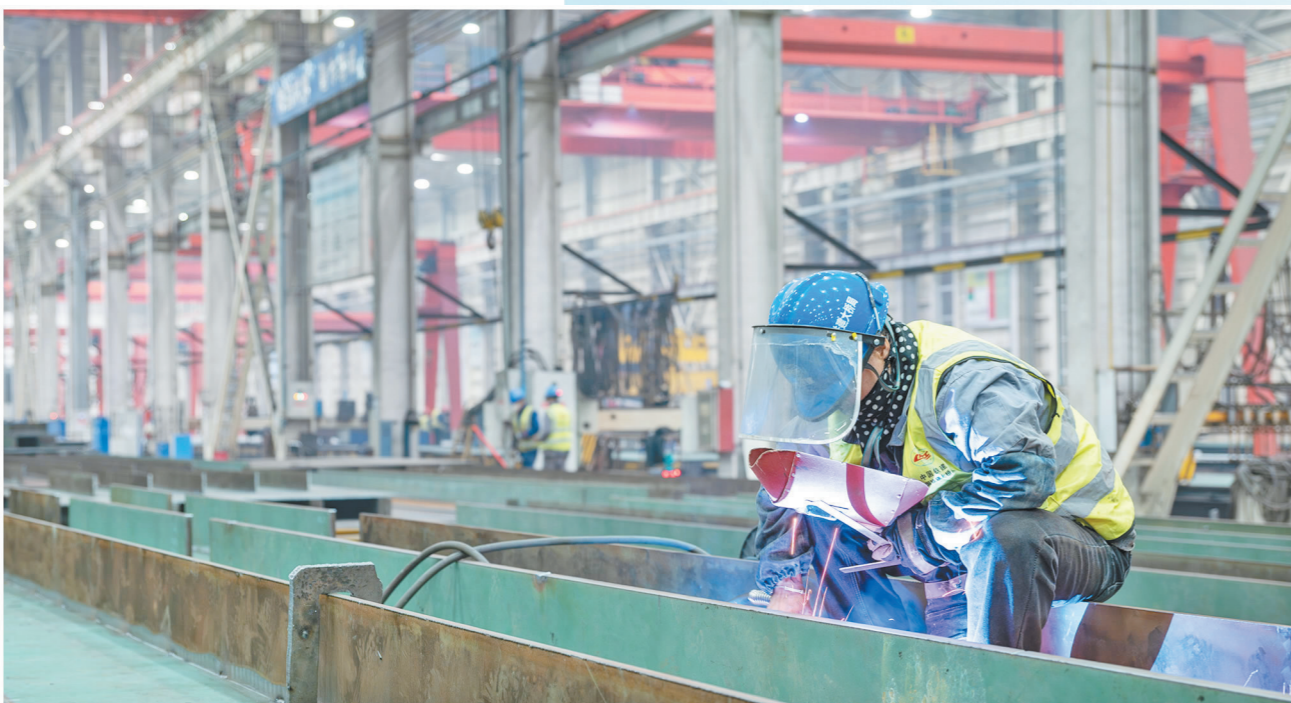
3月12日,在中国铁建大桥局靖江重工桥梁重钢生产制造车间,钢箱梁顶板单元组拼焊接制造正在火热进行中。 乔虎 摄
