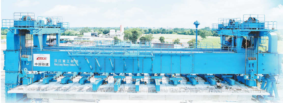
汉江重工自主研发的700吨节段拼装架桥机在泰国首条高铁中泰铁路投入使用
