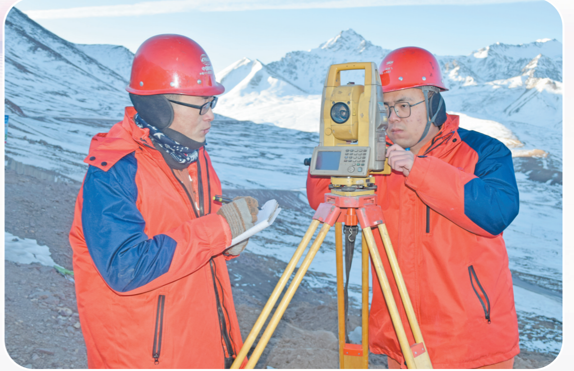
在海拔3500米的青海曼大公路项目,中铁十六局建设者为早日实现隧道贯通,战高原,斗严寒,元旦期间坚守一线有序施工。图为项目测量员在祁连山隧道洞外进行测量作业。李慧摄
