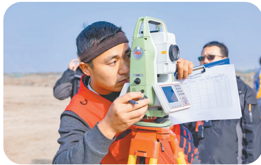
图为王小溪在赛场上进行竖井联系测量。 中铁十二局供图
