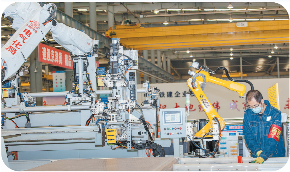
图为在具有浓厚新时代中国铁建文化氛围的京唐智能建造中心,项目员工在操作智能腕臂预配平台三代设备。
