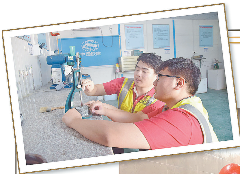
日前,中铁十七局六公司泉州二重环湾项目在导师带徒活动中,要求导师根据实际业务工作,为“徒弟”量身定做培训计划,帮助新员工快速适应岗位。图为师傅指导徒弟做水泥标准稠度用水量测定。薛亚平 摄
