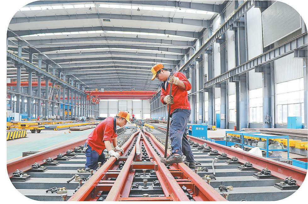
组装员工在生产线上对道岔进行调试。张新颖 摄
