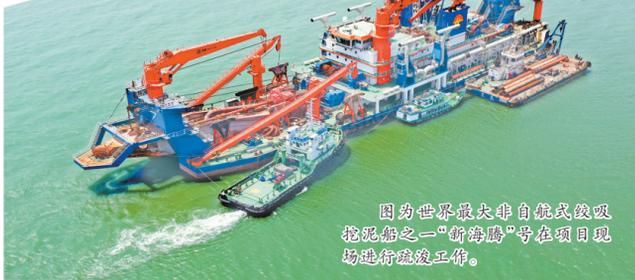
图为世界最大非自航式绞吸挖泥船之一“新海腾”号在项目现场进行疏浚工作。
