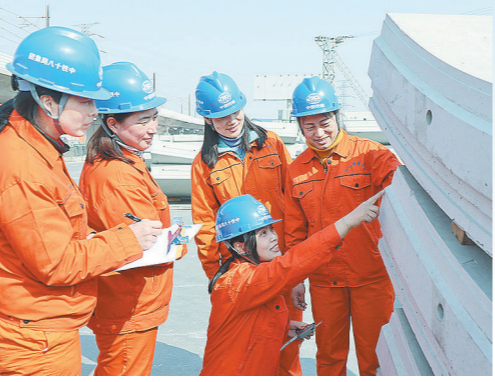
图为女工小组成员在检查管片外观质量。
