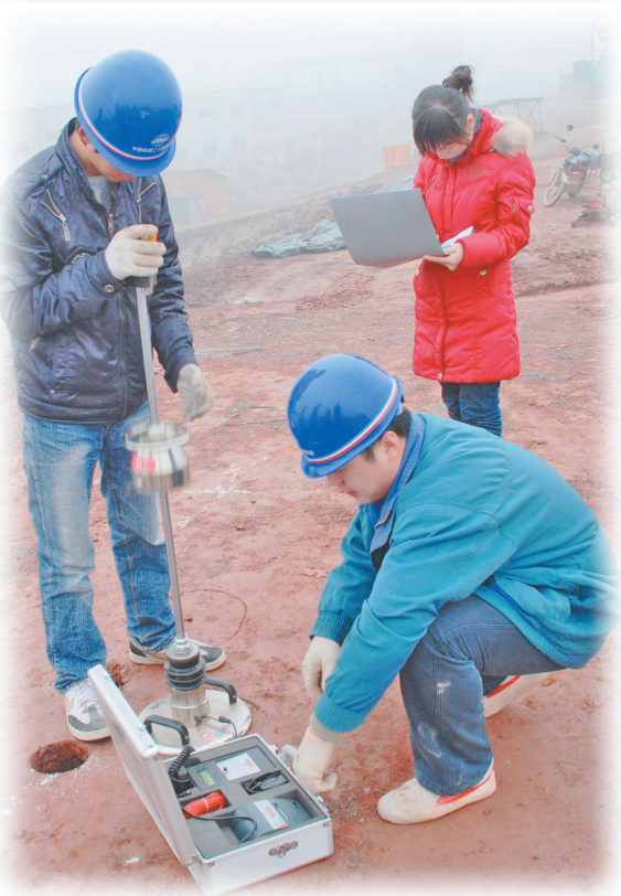
采用面波法精准检测
