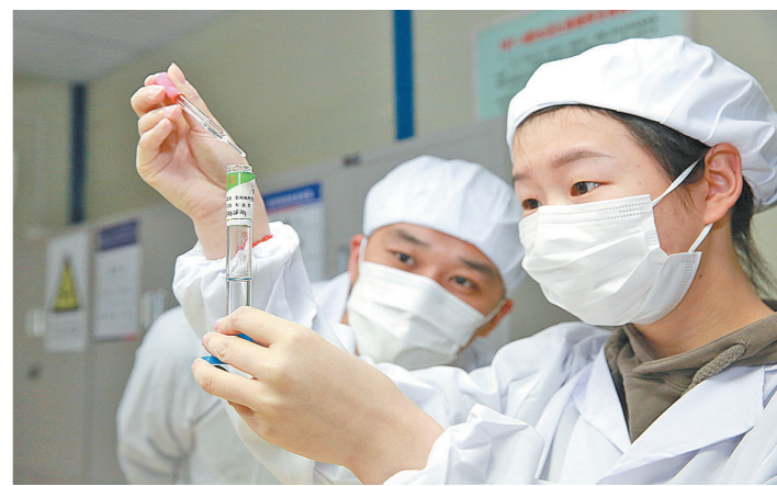
项目在隧道施工场地共修建了25个预沉池,通过四级甚至七级沉淀,然后采取油水分离、气浮过滤等处理,并将达标的清水循环使用,实现废水零排放。图为4月6日,安九项目试验员正在对已经沉淀处理后的废水进行检测。
