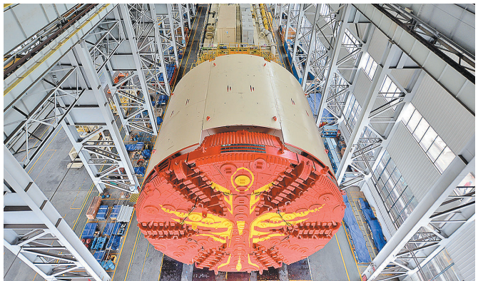
截止目前,铁建重工研制超过5台15米级及以上超大直径盾构机,进一步巩固了国产超大直径盾构机核心技术自主可控能力。图为3月2日,其中一台开挖直径15.02米的超大直径泥水平衡盾构机完成了刀盘组装机工作,即将参建安徽芜湖过江隧道。 黄杰 摄
