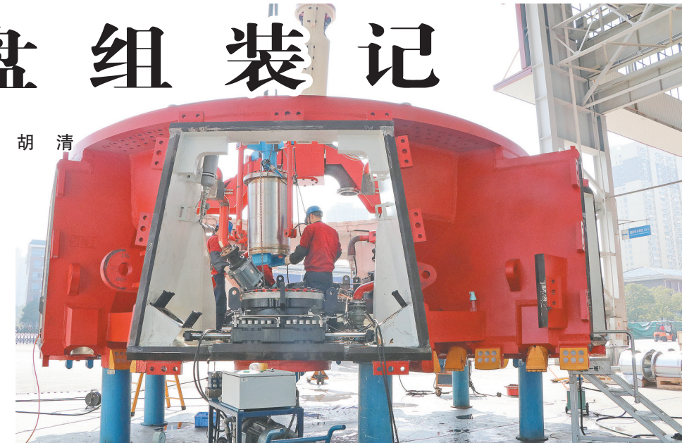
2月18日,在铁建重工长沙第一产业园,工人们正在进行刀盘保压调试。这是一台高15米、长94米的超大直径盾构机,2月底进行工厂验收,即将参建安徽芜湖过江隧道。
