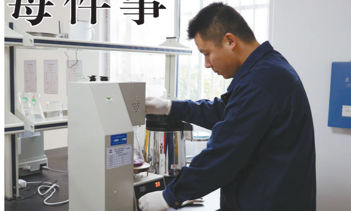
图为蔡凯在进行粉煤灰氧化钙含量试验。 许伟摄
