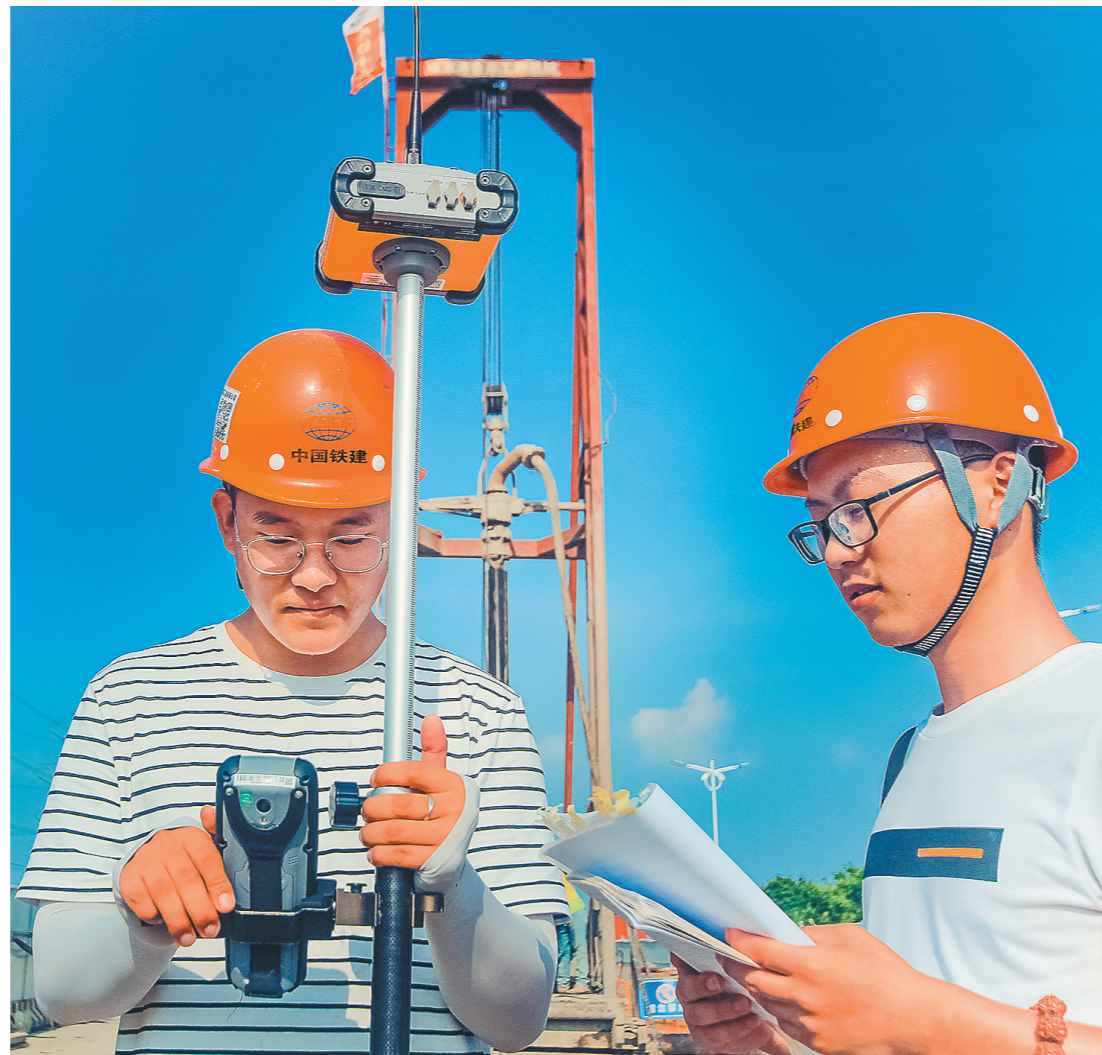
7月24日,中铁十六局三公司苏州南湖路项目部迎来了今年的第二批新员工——4名测量专业顶岗实习生,为帮助他们尽快适应并融入新环境,加快成长步伐,项目部强化“导师带徒”活动,在施工现场进行一对一教学。图为一位师傅正在指导徒弟进行换手测量。 汤伟伟 摄
