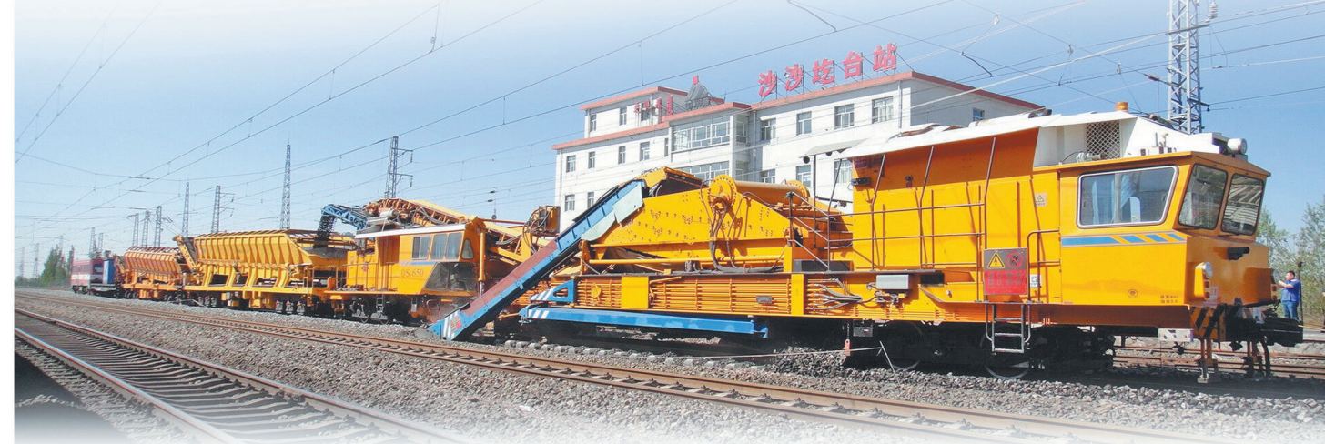
铁运公司包神铁路运营指挥部工务工区在沙圪坨站进行大机清筛作业。
