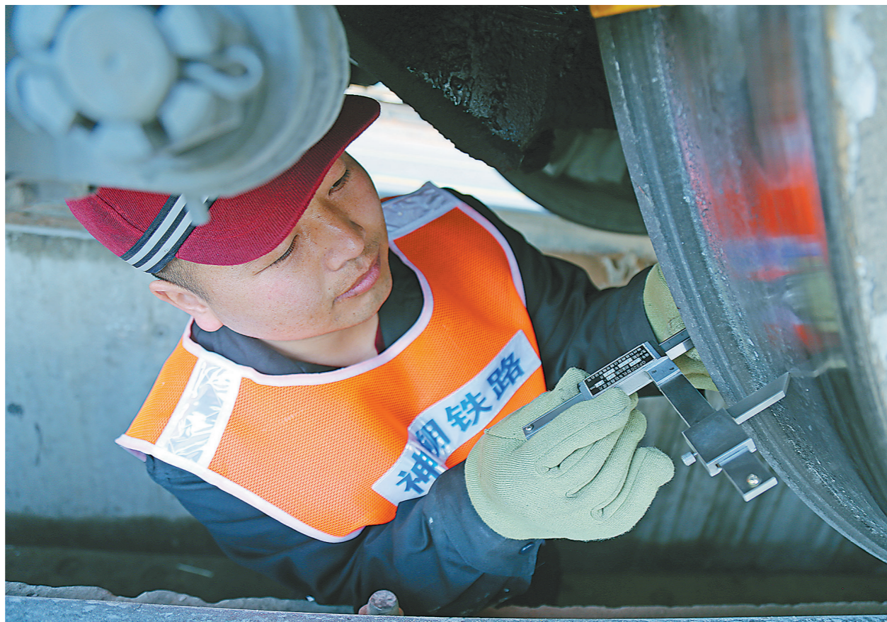
铁路运营是中铁二十局四公司的主营业务之一。为进一步提高机车检修整备质量,确保机车以良好状态投入运营,日前,该公司组织技术人员对所属机车进行全面鉴定整修,消除机车运行故障等隐患,确保行车安全。图为四公司员工正在检查机车轮缘数据。 黄天龙 摄
