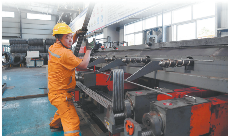
智能平式弯箍机加工管片箍筋。
