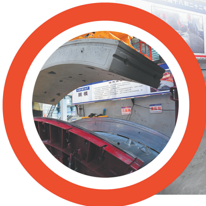
▲管片强度大于15兆帕后采用真空吸盘脱模。
