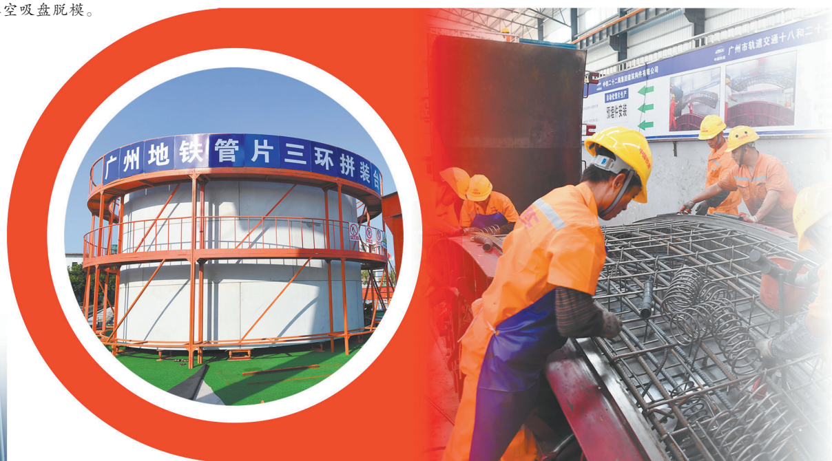
▲管片三环拼装试验台。
