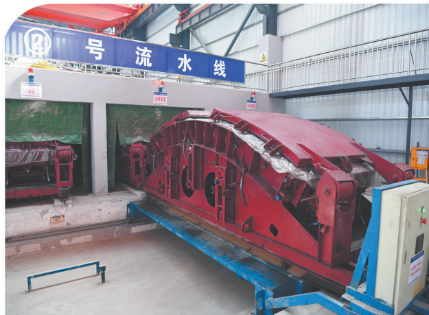
管片蒸养完成后通过平移小车送入脱模工位。
