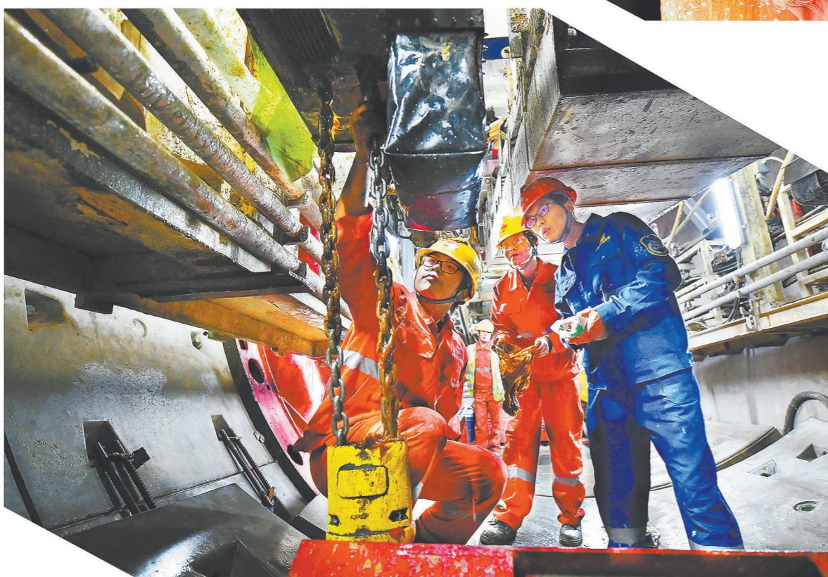
▼中铁十一局城轨公司建立完善的盾构设备维保机制,把机修工、电工、焊工等设备保养人员纳入盾构队管理,将设备维保情况与人员的绩效挂钩。图为维保人员在双轨梁上涂抹润滑油。
