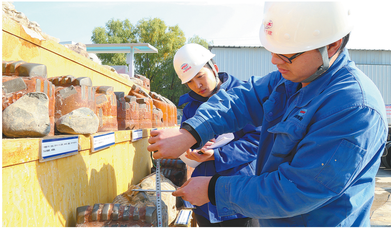
中铁十四局大盾构公司在青年员工中广泛开展比管理、比信誉、比责任、比形象、比成绩劳动竞赛活动,创造了北京隧道施工历史上单月掘进237环、474米的新纪录。图为日前该公司京张高铁清华园隧道盾构机长邱文建正在指导队员测量刀具磨损值,确保建设精品工程。
