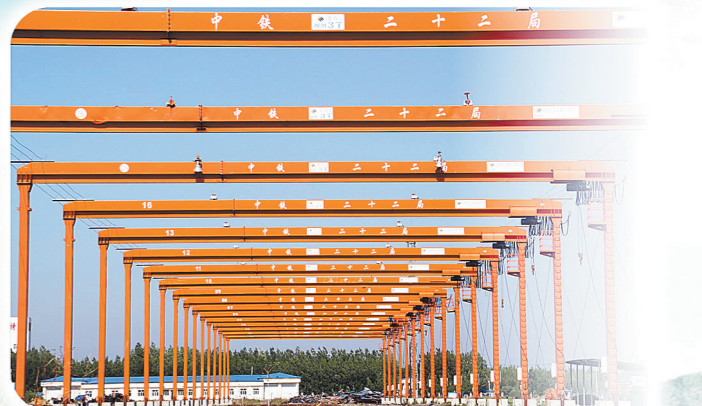
铺轨基地32台固定式龙门吊。
