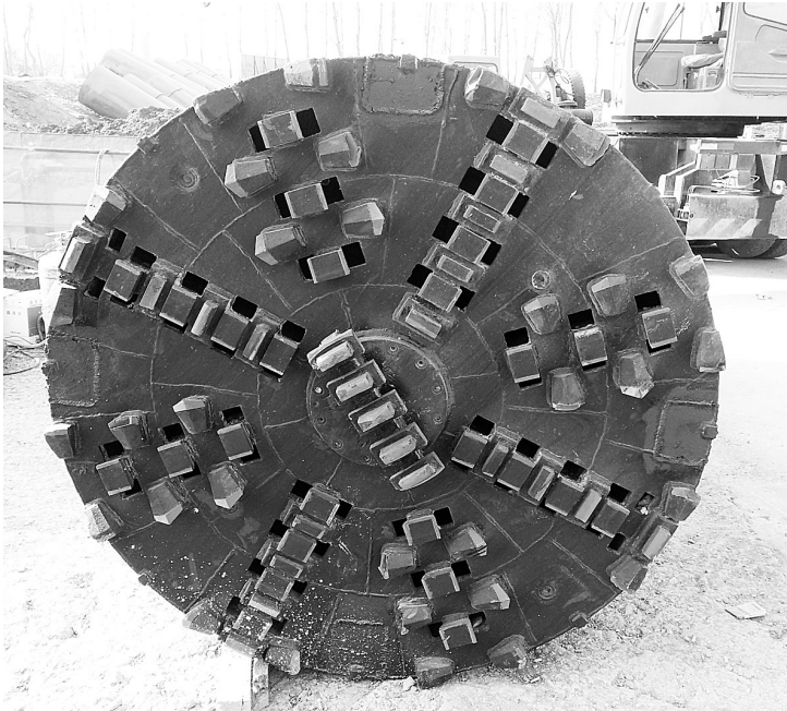
顶管施工用的旋转机头
