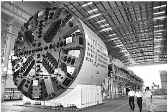
用于长株潭城际铁路施工的9.33米大直径盾构机
