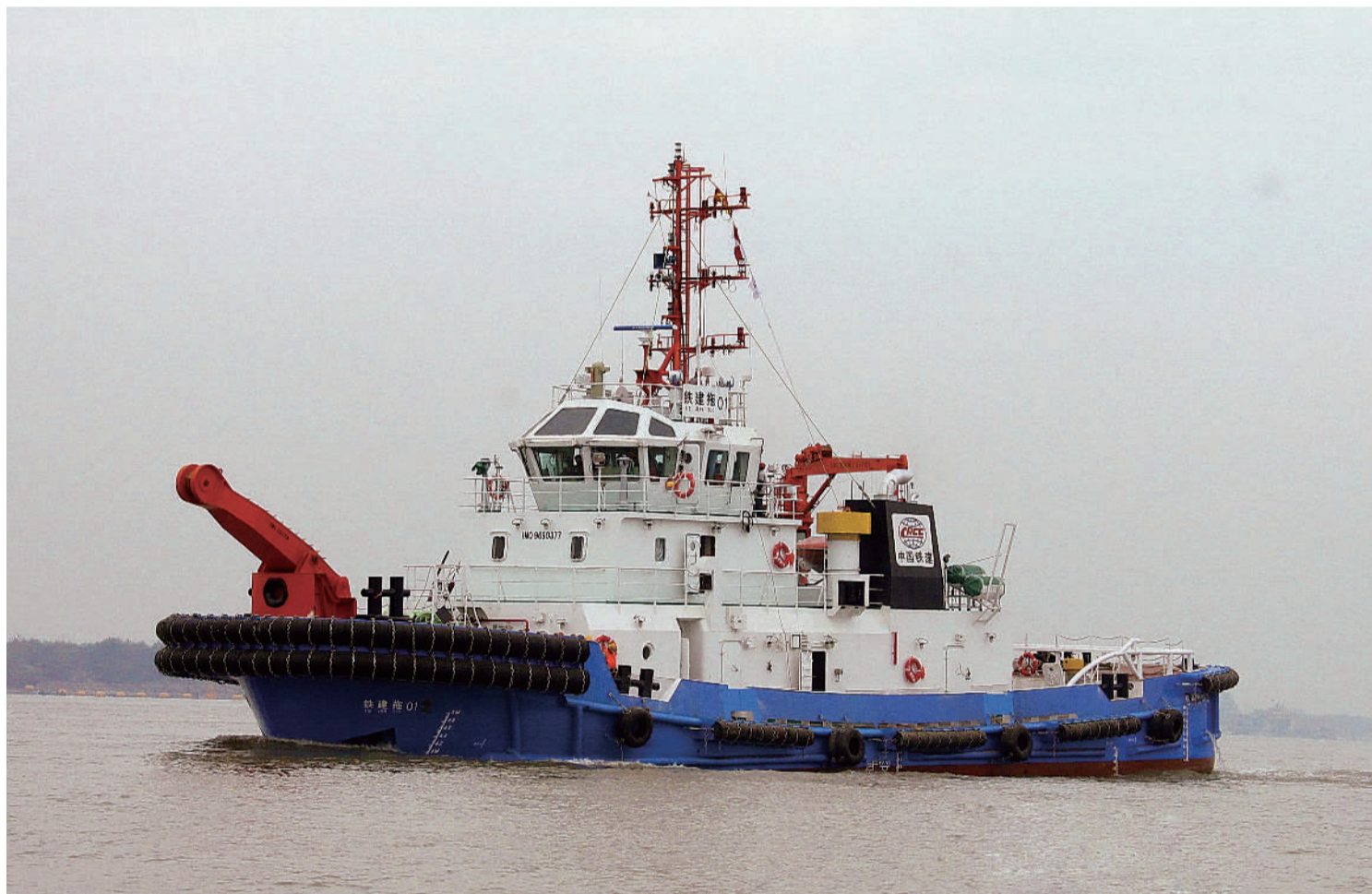
11月13日,由港航局集团投资建设的铁建拖01—4000HP全回转拖轮圆满完成了所有航行试验项目,预示着港航局集团向建设“水工领域领军企业”迈出了重要的一步。该拖轮于2013年2月26日在江苏口岸船厂开工兴建,船体总长39.2米,型宽11.6米,型深5米,设计吃水4米,是港航局集团第一批7艘核心工程船舶之一。
