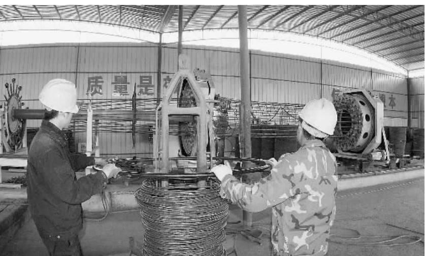
一工区率先引进全线第一台钢筋笼生产线
